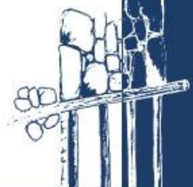
4 - Tailler l'extrémité des traverses de façon à les encastrer dans les montants.
